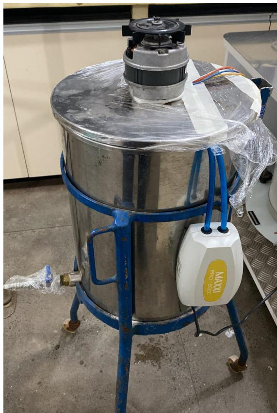
Figura 3.4 - Equipamento idealizado para fermentação das leveduras.
