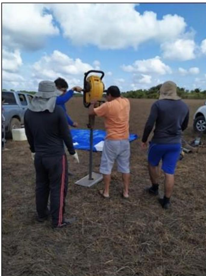
Figura 8 - Imagem de campo da utilização do RKS para a coleta do perfil de subsuperfície.
