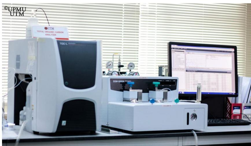
Figura 11- Analisador de carbono orgânico total TOC-L, marca Shimadzu (modelo SSM-5000A). Fonte utm.my.
