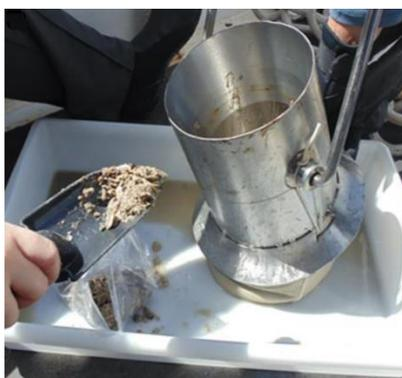
Figura 9- Draga de *Gibbs* utilizada durante a amostragem de sedimentos superficiais. Fonte: Santos 2019.
