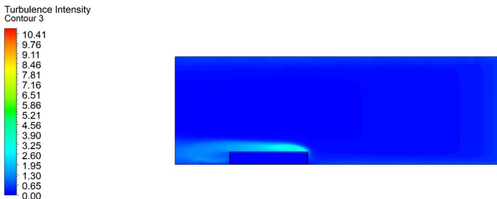
Figura 37 - Contorno da intensidade turbulenta sobre a superfície do vagão.
