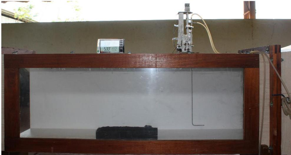
Figura 12 - Disposição do modelo de vagon no interior do túnel de vento.
