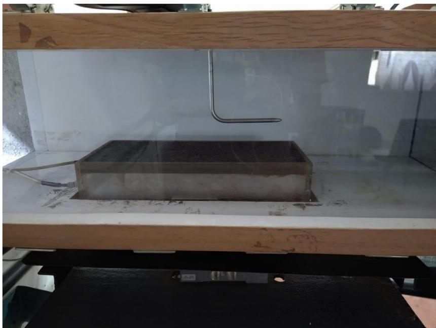
Figura 25 - Disposição do leito de minério de ferro no túnel de vento secador (SILVA, 2021).
