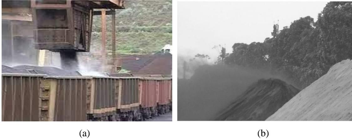
Figura 1 - Emissão de poeira em operações com minério: (a) carregamento de vagão (BARROS, 2008), (b) processo de erosão de uma pilha de minério (LOREDO-SOUZA *et. al.*, 2006).
