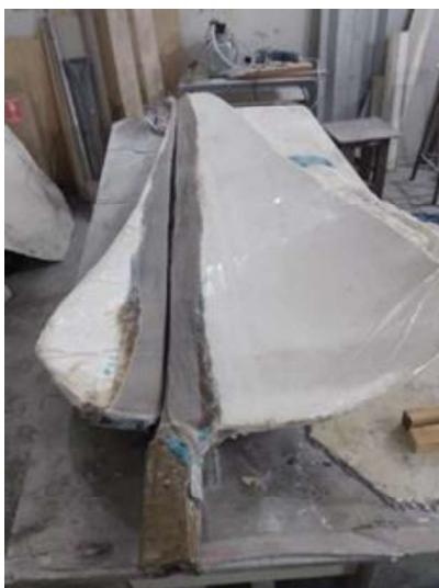
Figura 3. 9 - Acomodação da longarina e da haste de sustentação na pá eólica.
