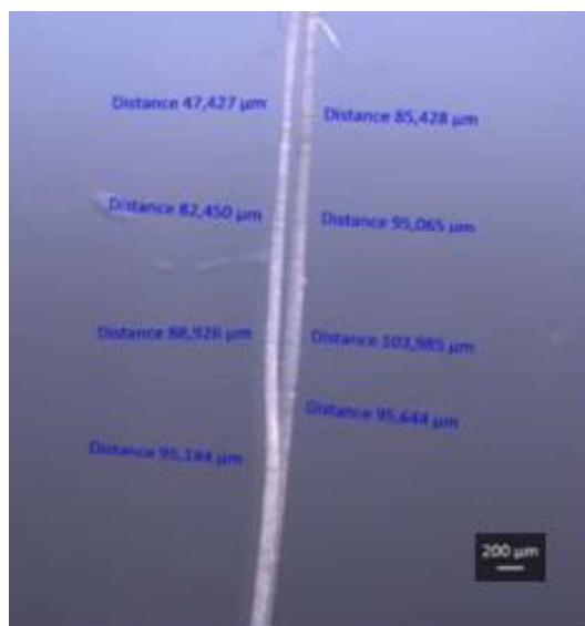
Figura 3. 14 - Fibra de Juta medido seu diâmetro em Microns.
