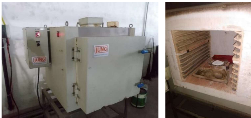
Figura 3.15 - Forno de Mufla utilizado para secagem do fio de juta e da fibra cardada
