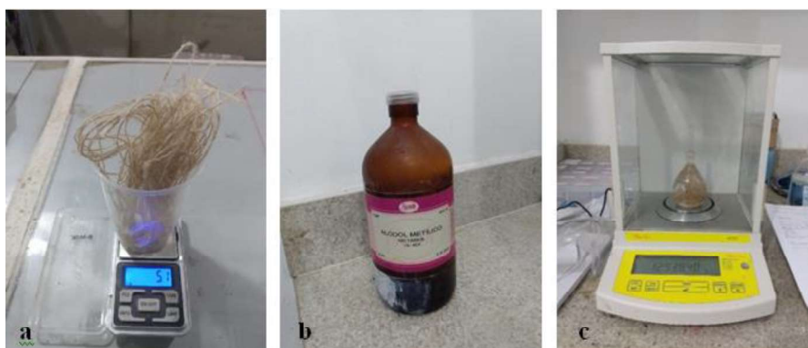
Figura 3.16 - Sequência de pesagem utilizando Picnômetro (a) fio de juta; (b) álcool metílico PA e (c) balança de precisão com picnômetro no interior.
