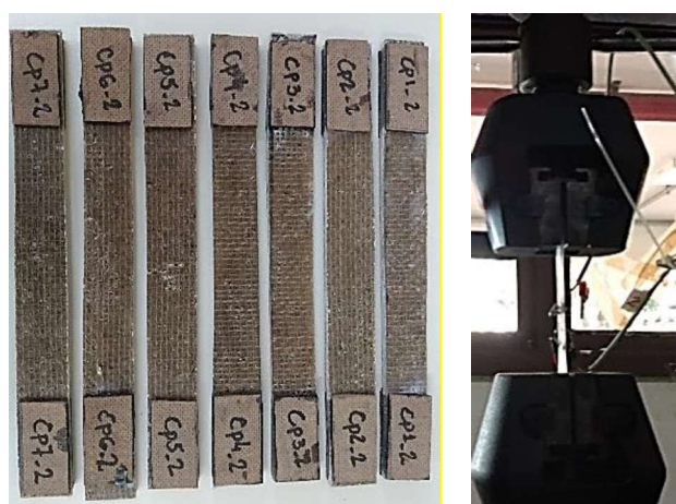
Figura 3. 24 - Corpos de prova de Juta/Epóxi sob ensaio de tração.
