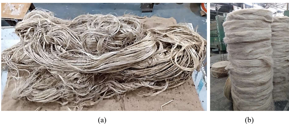
Figura 2. 11 - a) Fibra de juta in natura; b) fibra de juta após cardeamento.
