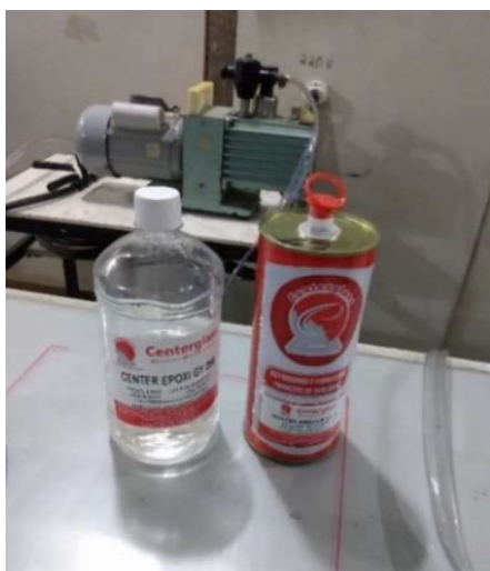
Figura 3. 17 - Resina epóxi e Isoforonadamina e álcool benzílico.
