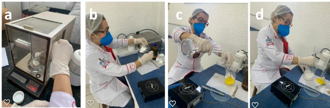
Figura 26: Representação ilustrativa das etapas de mistura dos componentes químicos. a- peso da suspensão de Ca(OH) 2 ; b- adição do Ca(OH) 2 ; c- adição da solução de H 3 PO 4 ; d- homogeneização.
