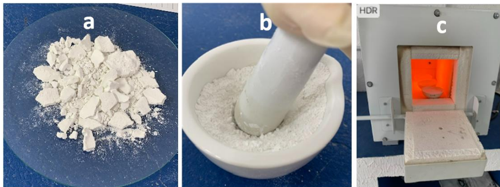
Figura 28: a- produto após a fase de secagem em estufa a 100\text{ }^\circ\text{C} ; b- cominuição; c- calcinação a 1000\text{ }^\circ\text{C} por 2h.
