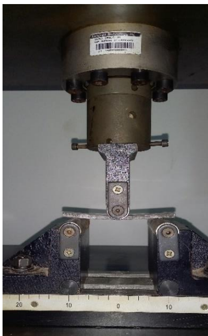
Figura 30. Equipamento para ensaio de flexão.
