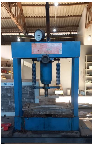
Figura 26. Material polimérico durante o processo de prensagem.
