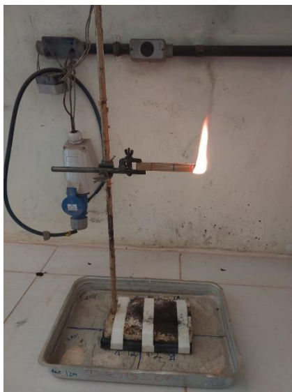
Figura 32. Ensaio de flamabilidade de material compósito.
