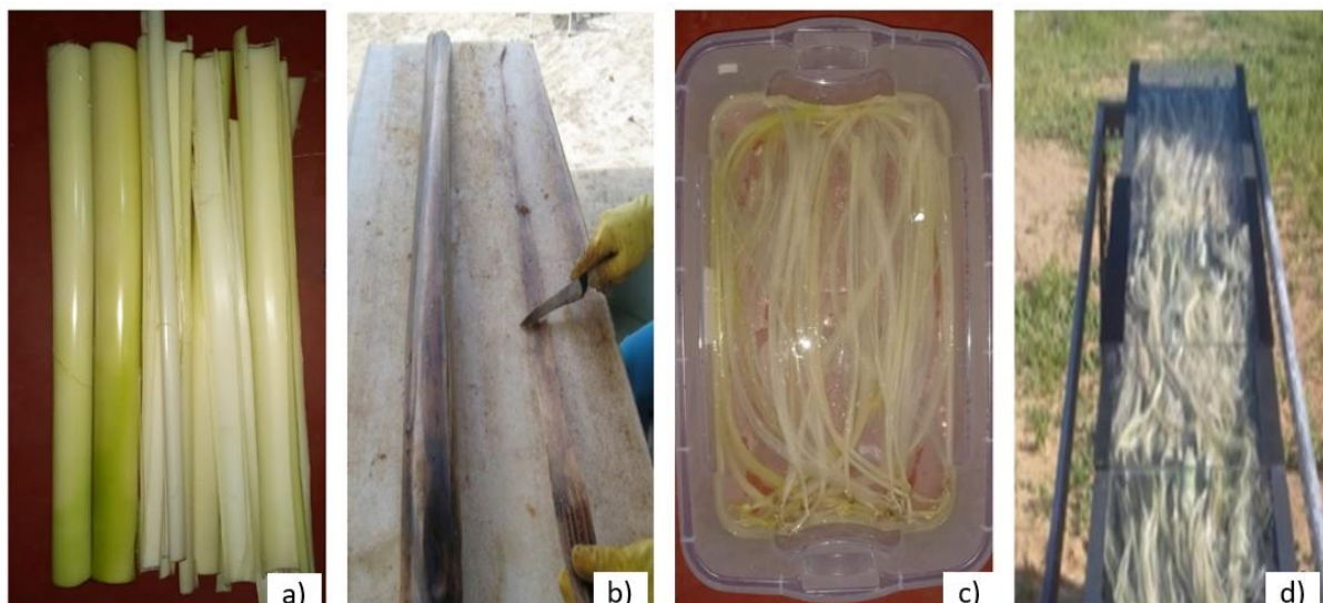
Figura 18. Processo de extração da fibra: a) separação das bainhas; b) retirada da estrutura vegetal; c) lavagem; d) secagem ao ar livre.
