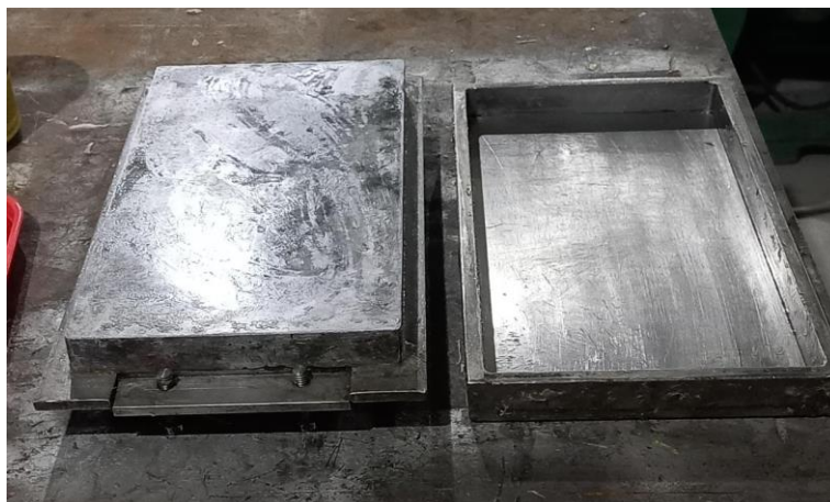
Figura 24. Molde utilizado para confecção das placas.
