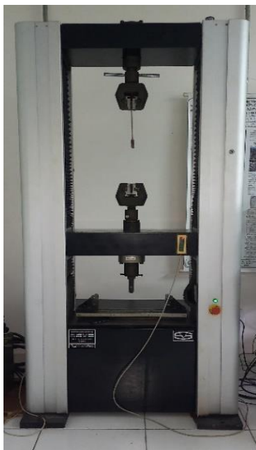
Figura 28. Equipamento para ensaio de tração.
