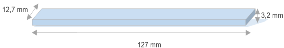
Figura 29. Dimensões dos corpos de prova ASTM D790 – 10.
