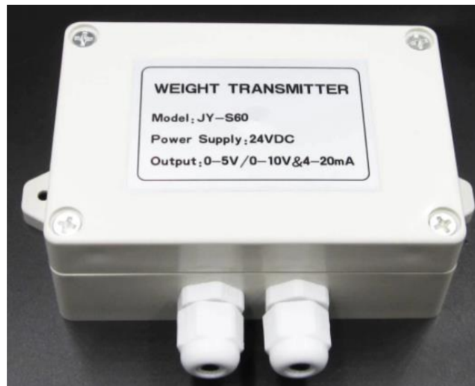
Figura 3.12 - Transmissor de pesagem modelo JY-S60
