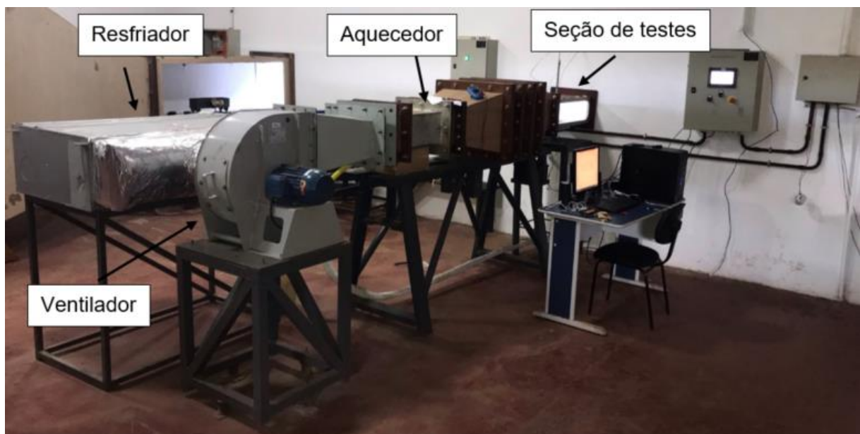
Figura 3.43 - Túnel de secagem dimensionado e montado.
