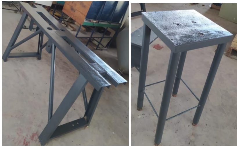
Figura 3.27 - Adaptação e pintura das bases metálicas existentes.
