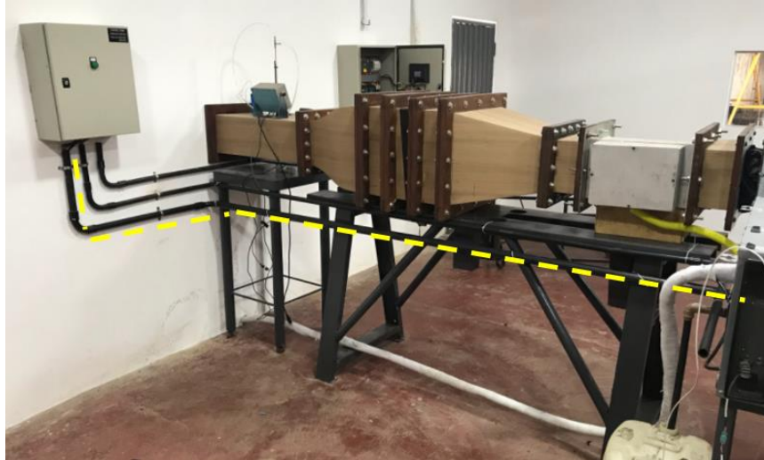
Figura 3.30 - Posicionamento dos eletrodutos.
