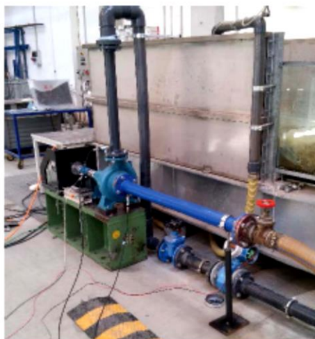
Figura 4.1 - Bancada de teste usada para realizar testes na bomba selecionada no modo turbina. Fonte: Rossi et al. (2019).
