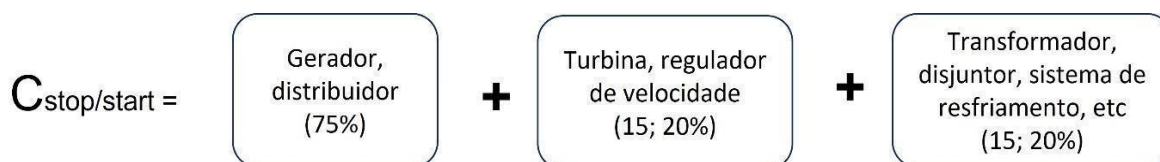
Figura 2.10 - Custo por componente/sistema e sua contribuição para o custo estimado total. Fonte: Savin et al (2021)
