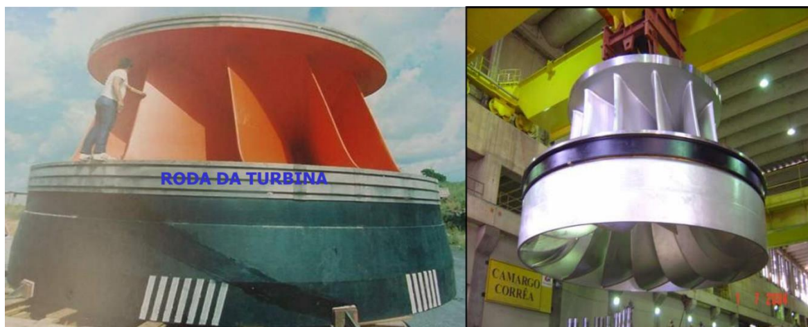
Figura 3.11 - Visão geral da turbina Francis de Tucuruí. A esquerda foi utilizada na primeira casa de força 1 e a direita utilizada na casa de força 2. Fonte: Acervo Eletrobrás Eletronorte (1985 e 2004)
