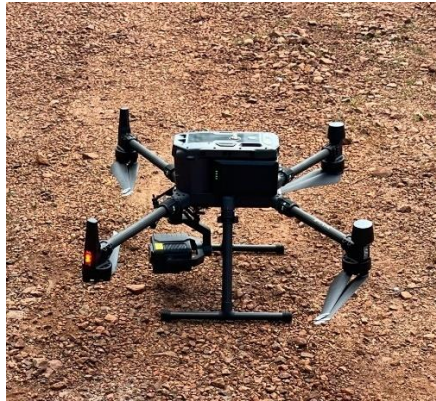
Figura 15 – Equipamento termo visor infravermelho embarcado em RPA.
