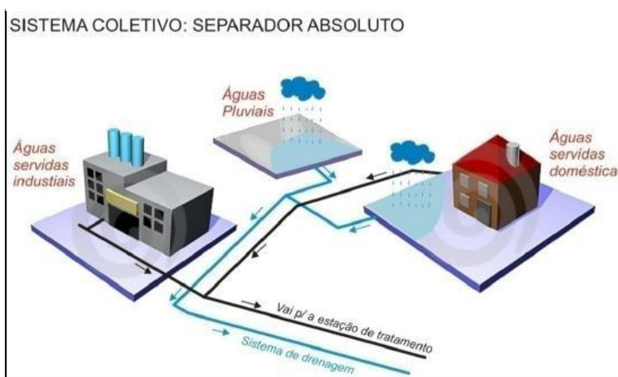
Figura 3 – Sistema de esgotamento sanitário tipo separador absoluto.
