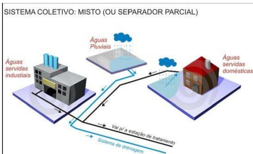
Figura 2 – Sistema de esgotamento sanitário tipo misto.
