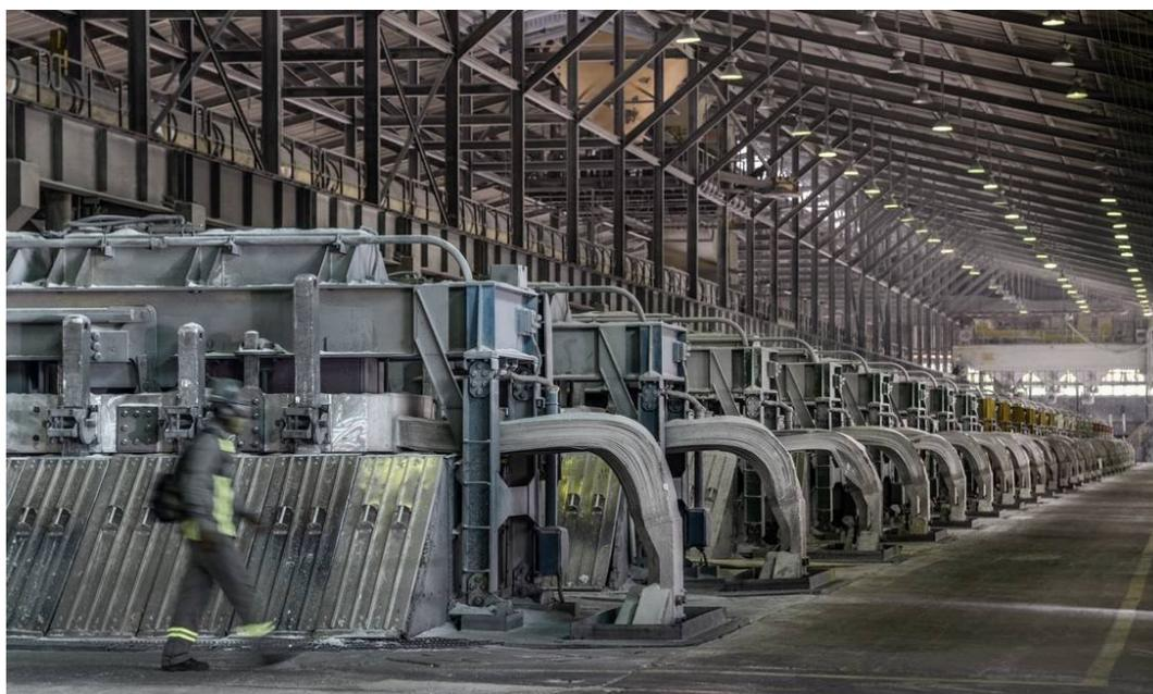
Figura 1.1: *Circuito formado por várias cubas de redução de alumínio conectadas eletricamente - Potline. Adaptada de [6]*
