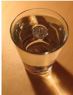
Figura 3.11: Moeda sobre a água em função da tensão superficial
