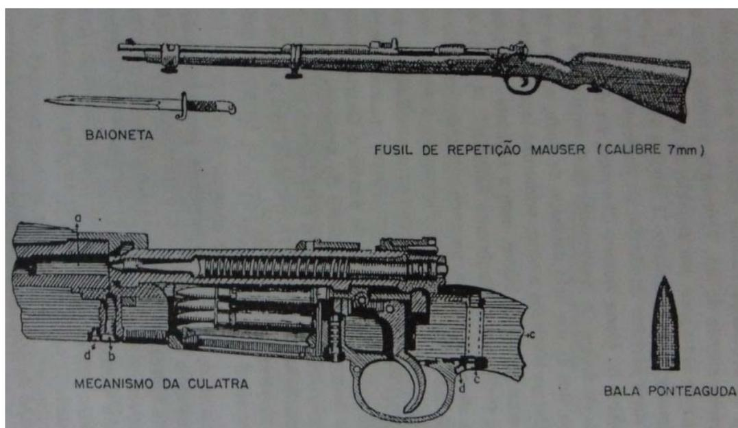
Figura 13: Rifle Mauser M1895 com a caixa da culatra em detalhe.<sup>164</sup>
