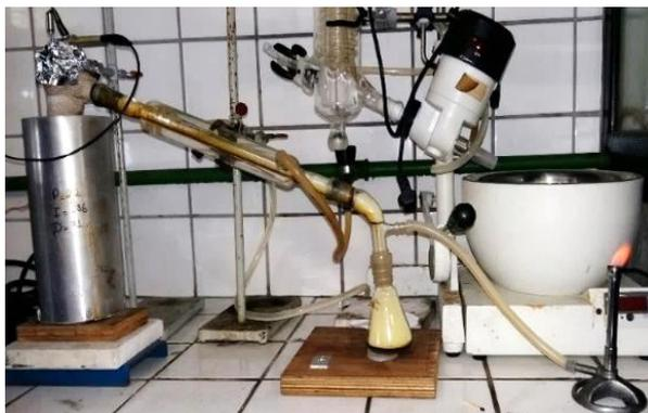
Figura 16 – Aparato experimental de pirólise em escala de laboratório
