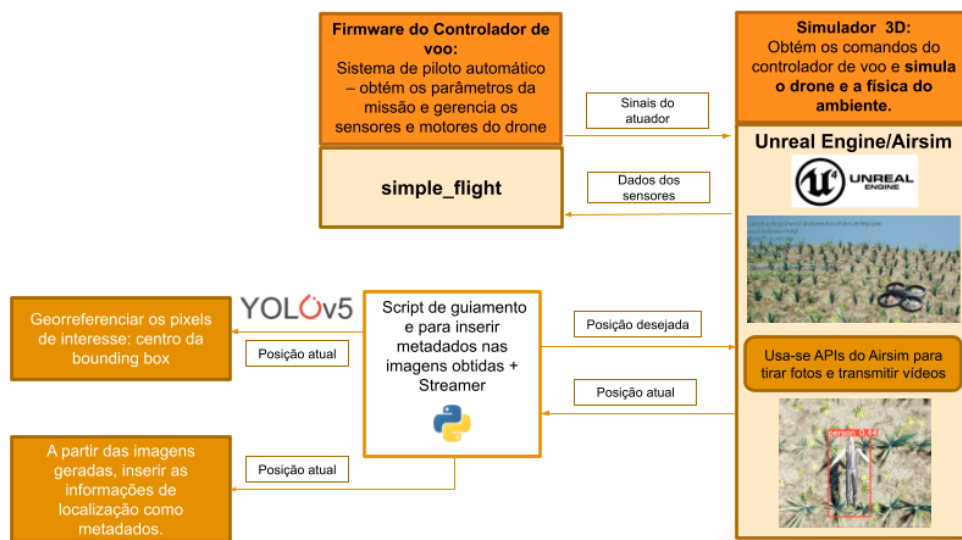
Figura 4.3: Diagrama de blocos da simulação implementada com o controlador de vôo simple_flight .
