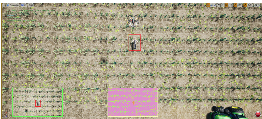
Figura 4.10: Posicionamento do drone acima da pessoa deitada usando a posição GPS retornada pelo algoritmo de georreferenciamento.
