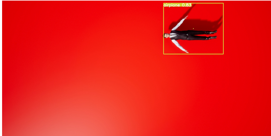
Figura 4.14: Imagem obtida com o drone voando a 5.4 metros de altura em relação à pessoa detectada pela YOLOv5 ( \psi_G = 90^\circ ).
