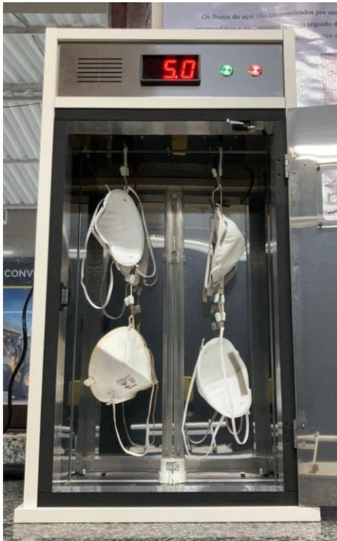
Figura 26 - Dispositivo UV-C com sistema de rotação das máscaras N95 (Fonte: Autora, 2024).
