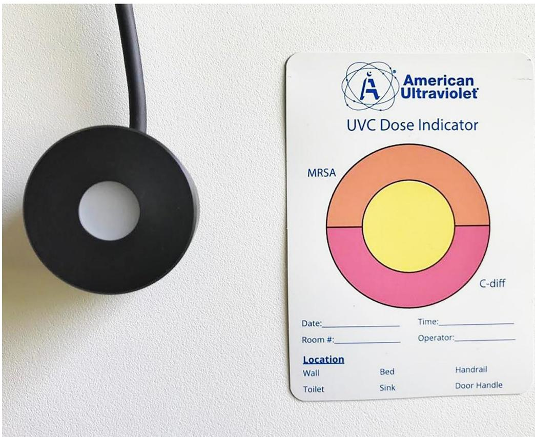
Figura 31 - a) sonda UV-C de radiômetro eletrônico b) indicador colorimétrico (Fonte: Autora, 2022)
