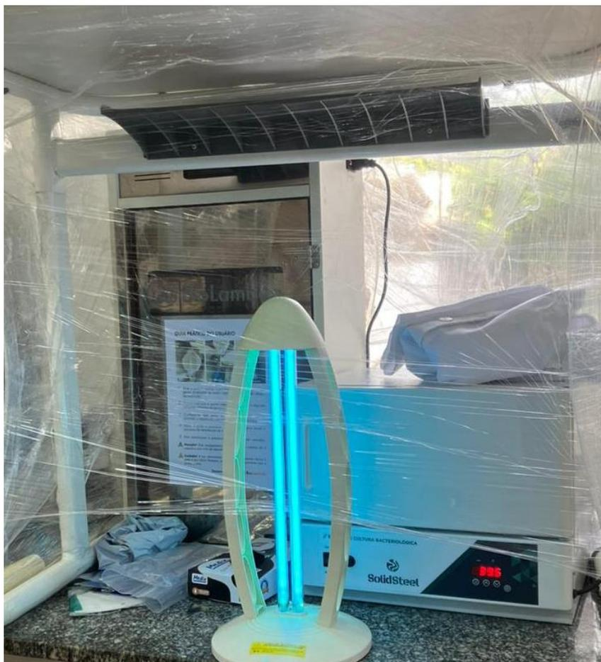
Figura 29 - Descontaminação da capela de fluxo laminar com uso de lâmpada UV-C (Fonte: Autora, 2024).
