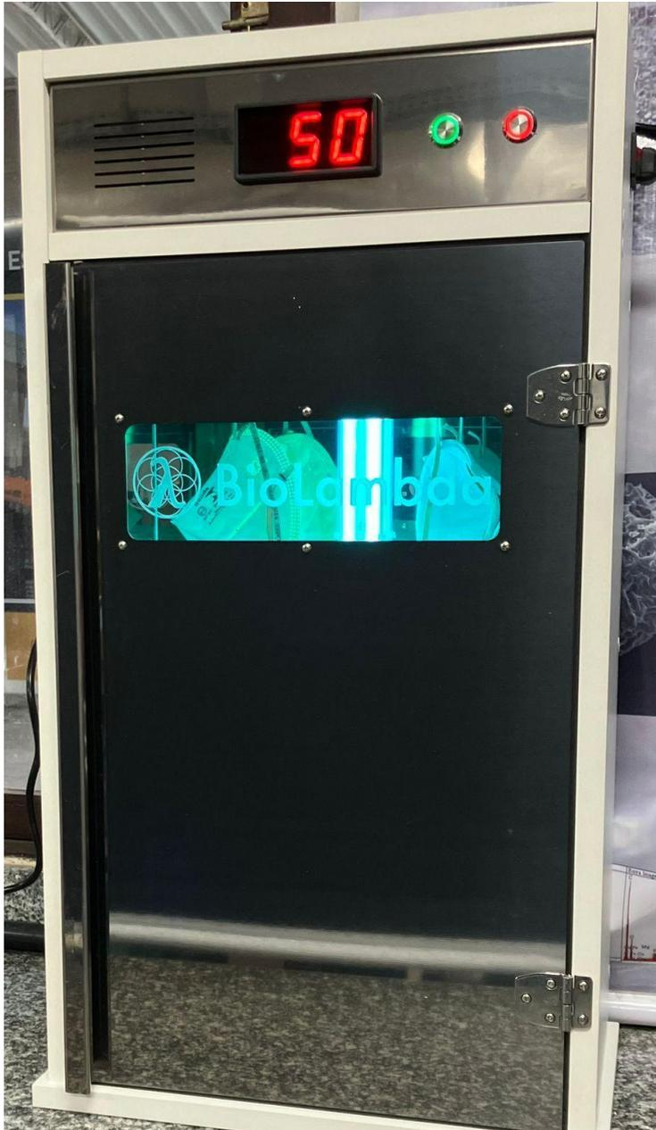
Figura 25 - Dispositivo UV-C com sistema de rotação das máscaras N95 (Fonte: Autora, 2024).
