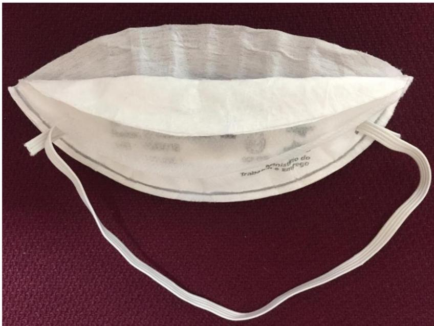
Figura 4: Camadas principais que compõem a concha da máscara N95, modelo 8801 da 3M (camada externa, camada filtrante, camada interna). Fonte: Autora, 2022.
