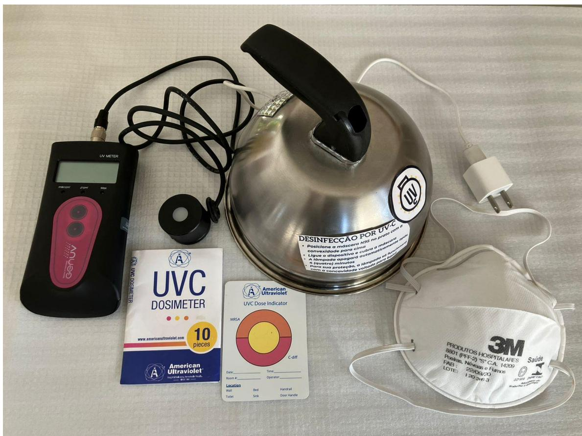
Figura 24 - Radiômetro com sonda UV-C, cartão dosímetro UV-C, dispositivo UV-C, máscara N95 (Fonte: Autora, 2023).
