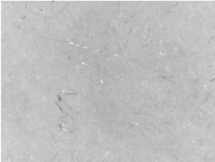
Figura 7 - Microscopia óptica da camada filtrante do respirador N95, modelo 8801 3M
