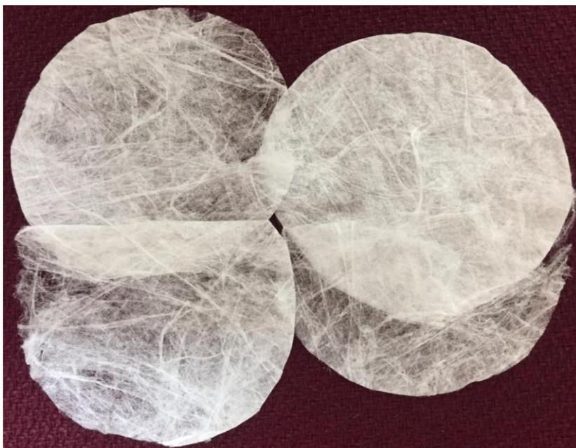
Figura 5 - Camada filtrante do respirador N95, modelo 8801 da 3M, separada manualmente em sub-camadas. Fonte: Autora, 2022.
