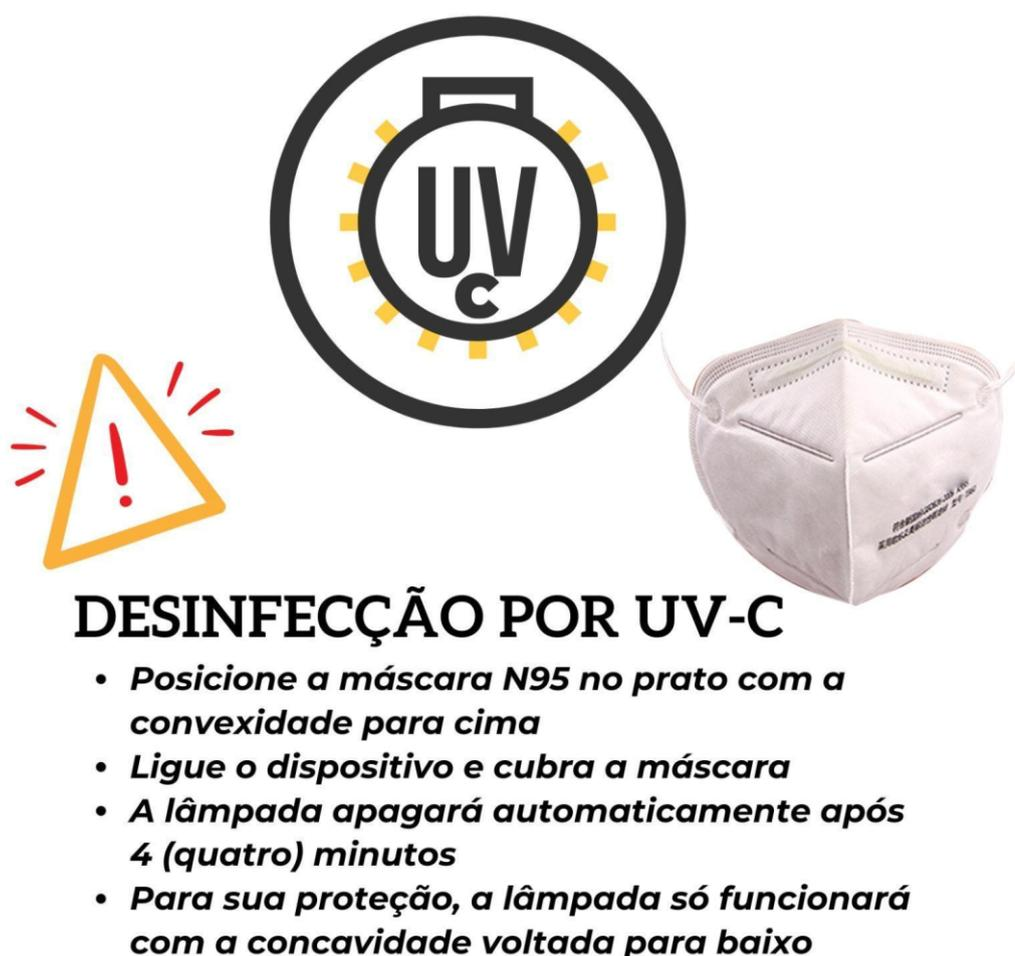
Figura 33 - Instrução de uso afixada no dispositivo simplificado para descontaminação UV-C (Fonte: Autora, 2022)
