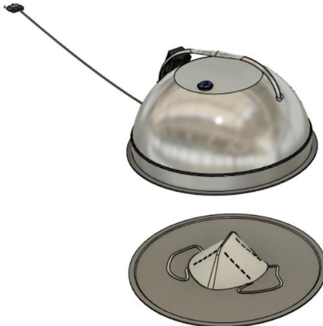
Figura 23 - Detalhamento do dispositivo para descontaminação individual de máscara N95 (Fonte: Autora, 2022)..
