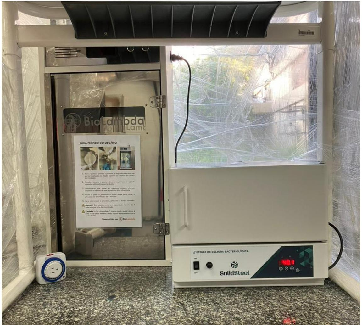
Figura 28 - Capela de fluxo laminar montada pelas pesquisadoras, na qual se vê o dispositivo de descontaminação UV-C e a estufa bacteriológica (Fonte: Autora, 2024).
