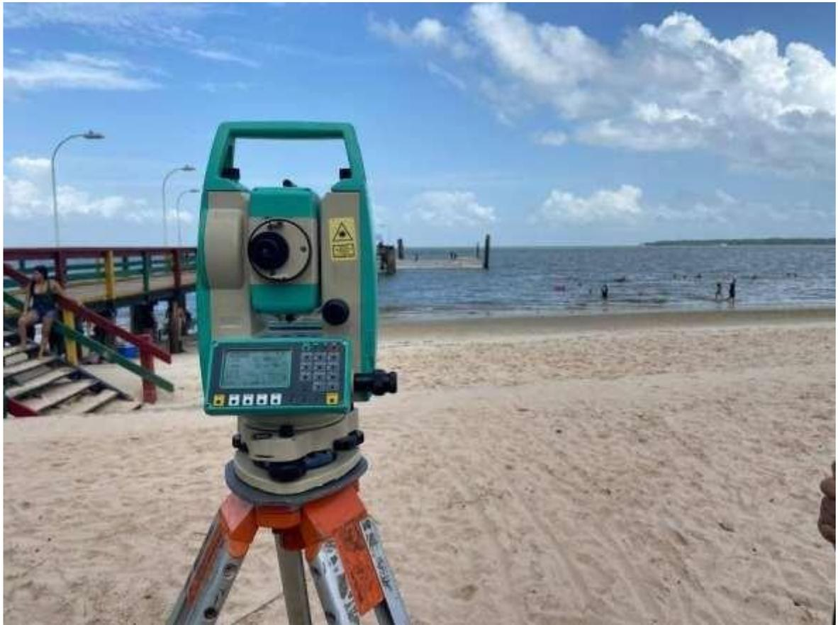
Figura 6 – Equipamento utilizado para o levantamento topográfico: Estação Total, modelo RUIDE RTS-822R<sup>3</sup>.
