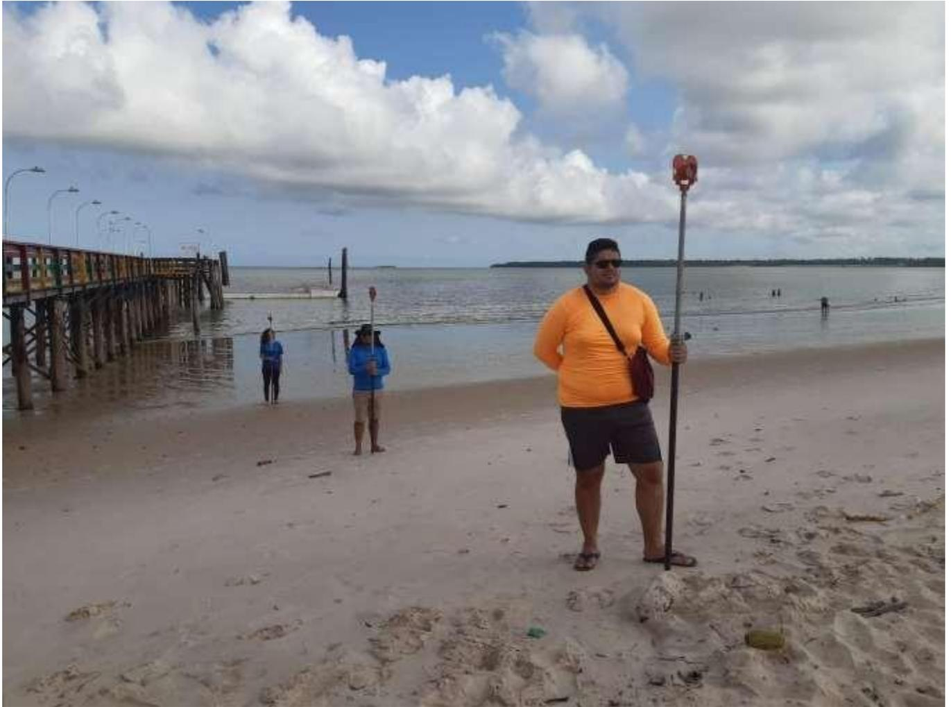
Figura 5 – Posicionamento dos 3 prismas para leitura dos dados pela Estação Total.
