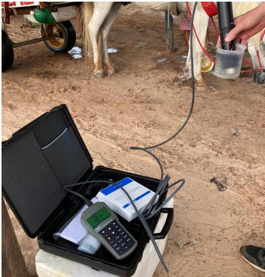
Figura 9- Análise de água coletada na Vila de Algodual por meio do analisador multiparâmetro.
