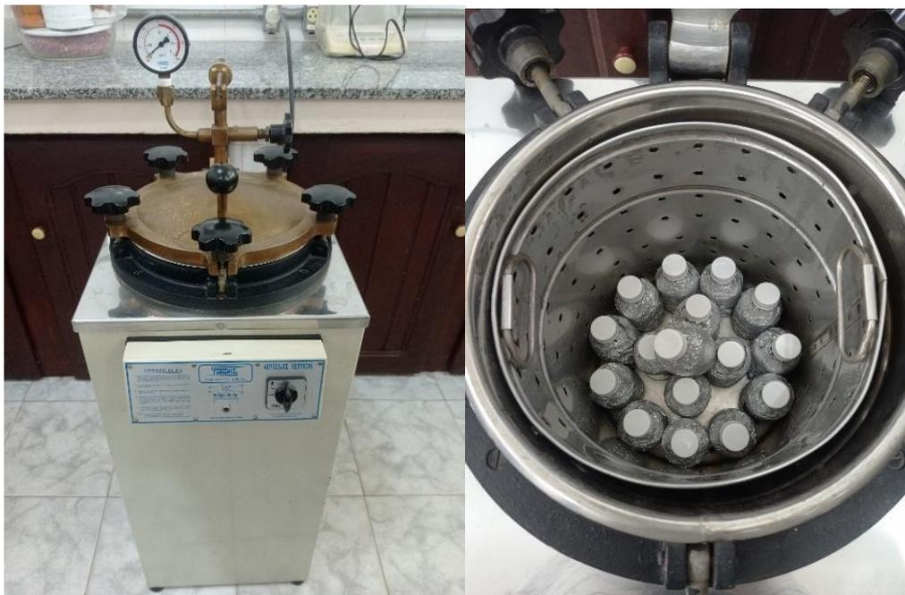
Figura 23- Descontaminação dos frascos com uso de autoclave.
