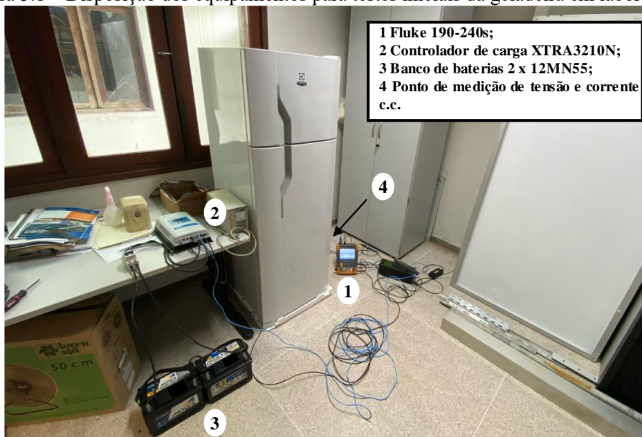
Figura 5.1 – Disposição dos equipamentos para testes iniciais da geladeira em laboratório.
