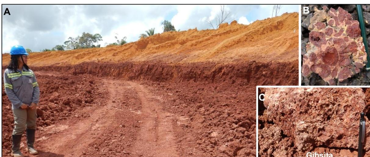
Figura 23- Disposição típica de perfil PHD, com horizonte bauxítico em contato com cobertura argilosa (A), textura pisolítica (B) e nodular (C) do horizonte bauxítico. Fonte: Roseane Sarges.
