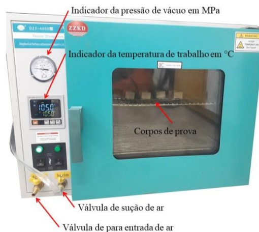
Figura 4.9 – Amostras no forno a vácuo.
