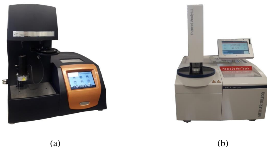
Figura 3.3 – Equipamentos usados no experimentos de (a) TGA e (b) DSC.
