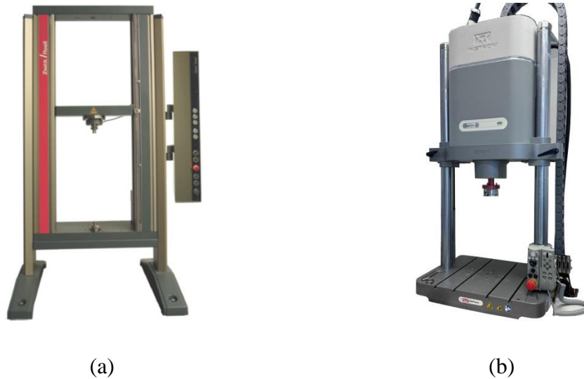
Figura 3.4 – (a) Máquina de ensaio usada nos testes de tração, compressão, flexão e cisalhamento e (b) máquina para ensaio de fadiga.
