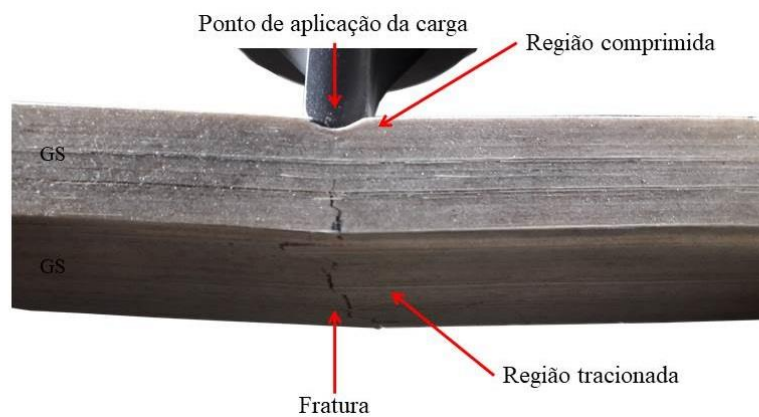
Figura 5.35 – Aspecto da fratura em flexão do PMP.
