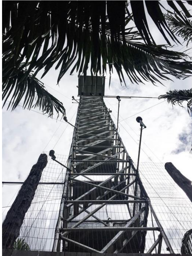
Figura 6 - Torre micrometeorológica com o termohigrômetros e anemômetros instalados
