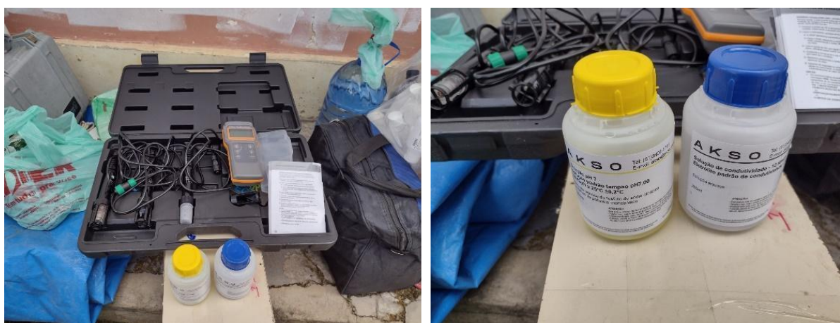
Figura 4 - Equipamentos de medição in loco: Sonda multiparâmetro (a) e soluções de calibração (b)
