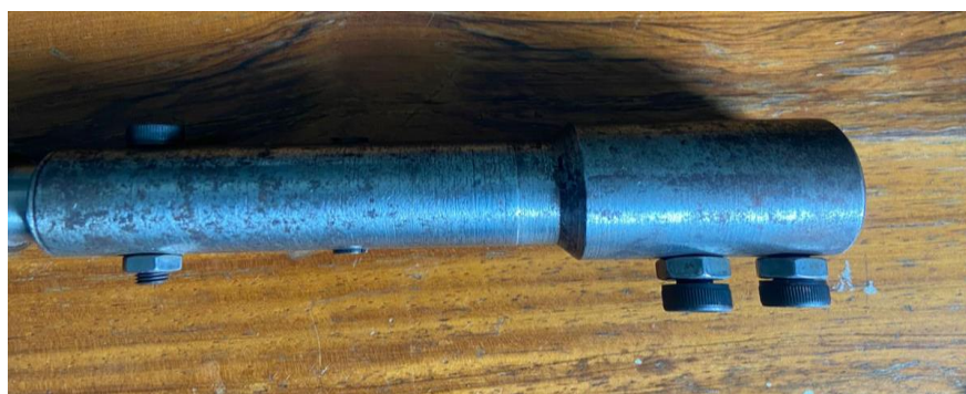
Figura 4.14 – Luva de fixação do eixo motor + eixo rosca Fonte: O autor (2024).
