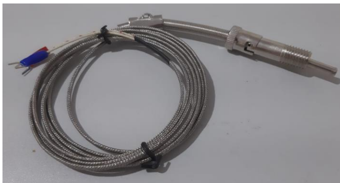
Figura 3.8 – Termopar Tipo K. Fonte: Autoria própria (2022)
