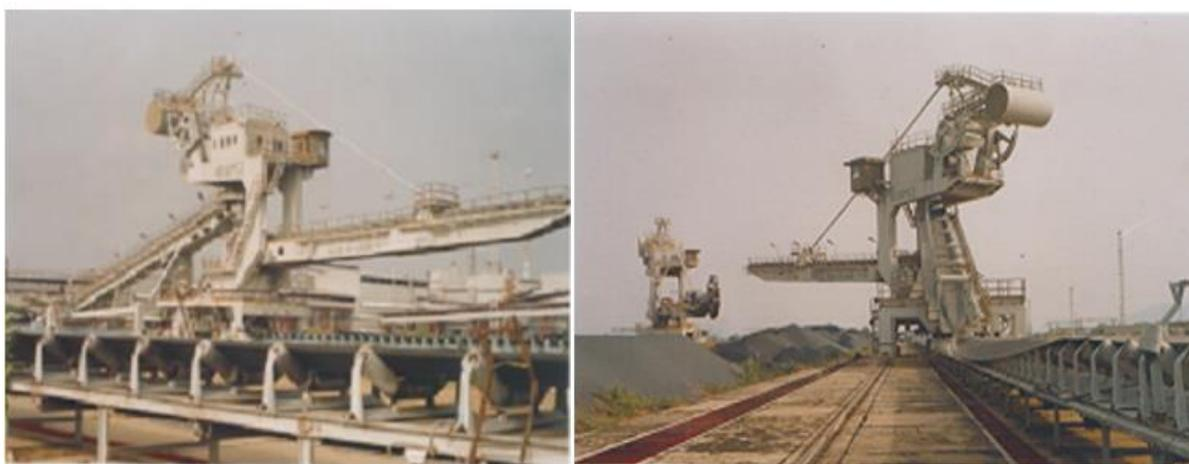
**Figura 2.3 – Equipamento utilizado para empilhamento de minério.**
