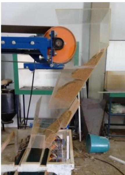
**Figura 3.1 – Bancada de transportadores para ensaios em chutes de transferência.**
