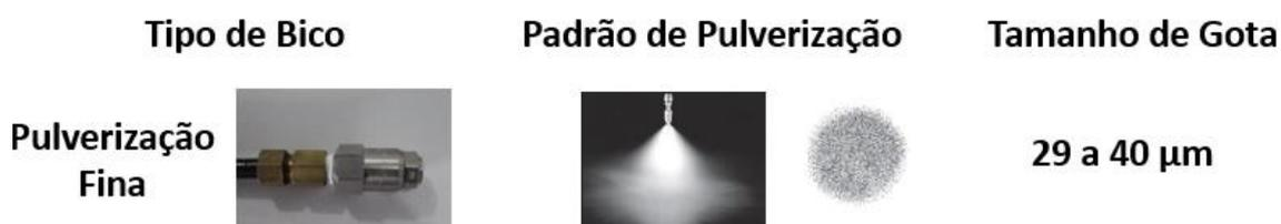
**Figura 5.2 – Bico de spray de pulverização fina.**
