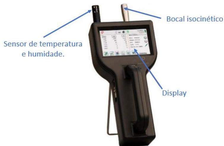
**Figura 3.10 – Contador de partículas Particles Plus 8506.**
