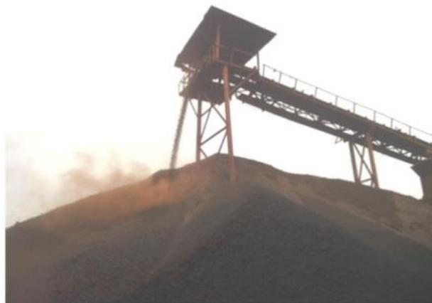
**Figura 2.4 – Emissão de poeira no processo de transferência de material em queda livre.**
