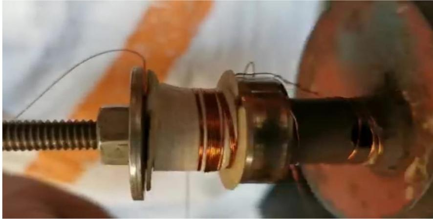
Fig. 21 Bobina do transformador de ferrite.
