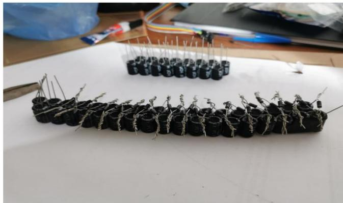
Fig. 18 – Organização dos capacitores no circuito CW.
