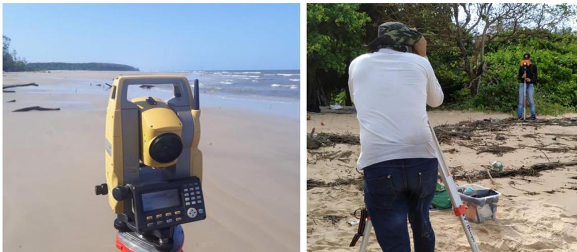
Figura 13 - Estação total e prisma refletor utilizados no levantamento topográfico. Fotografias retiradas em 13/09/2019.
