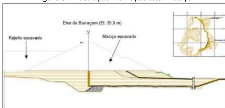
Figura 3 – Ilustração Remoção total maciço
