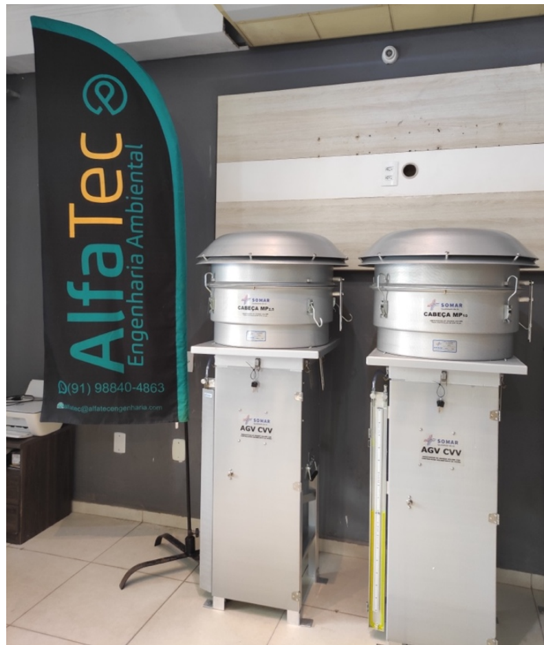
Figura 3 – Amostradores de Grande Volume com Controladores Volumétricos de Vazão (AGV-CVV).
