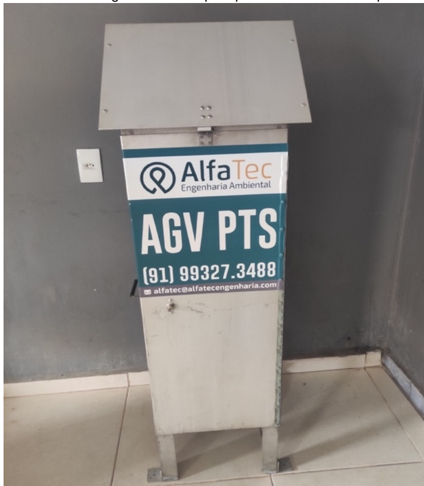
Figura 6 – Amostrador de grande volume para partículas totais em suspensão
