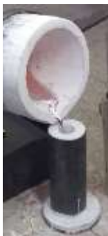
Figura 14 Vazamento da amostra testemunho
