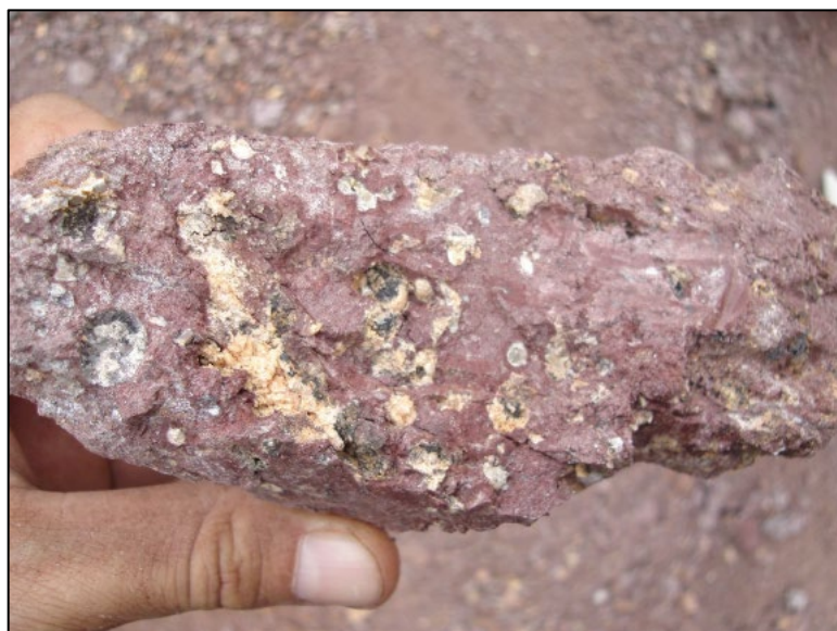
Figura 8- Amostra de mão do saprólito basáltico amigdaloidal da Formosa. Tanto a matriz vermelha quanto as amígdalas brancas são constituídas predominantemente por esmectita. Fonte: Paz (2010).
