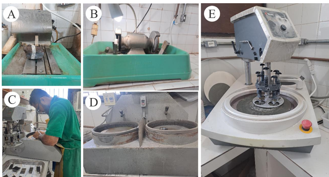
Figura 05- Preparação das lâminas delgadas. (A) Serratriz Hillquist utilizada para formatação da sessão a ser laminada. (B) Máquina de corte e desbaste utilizada para fazer a separação do bloco após a montagem da lâmina. (C) e (D) Desbastadora utilizada para fazer o desbaste das lâminas e também na preparação do bloco para posterior colagem. (E) Pilitriz Struers utilizada para polimento das lâminas.
