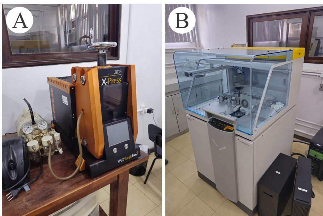
Figura 07- Equipamentos da Fluorescência de Raios X. (A) Prensa utilizada na confecção das pastilhas para análise. (B) espectrômetro WDS sequencial, modelo Axios Minerals da marca PANalytical.
