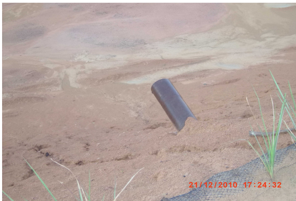
Fotografia 10 - Tubo que joga a bauxita para Bacia. Foto da própria autora. Pesquisa de campo (2010).
