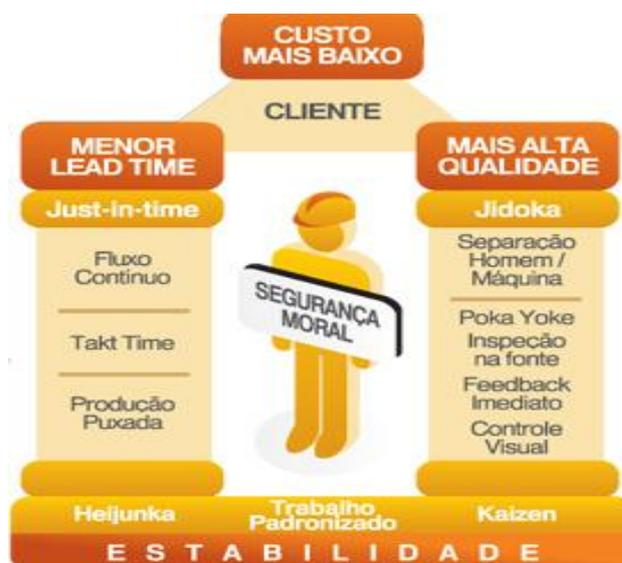
**Figura 2.1:** A estrutura do Sistema Toyota de Produção
