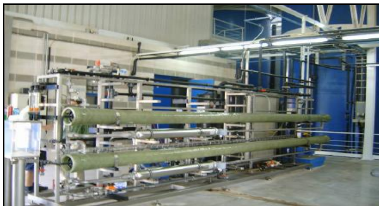
Figura 14 - Vista da instalação de “nano filtração existente no “aterro sanitário de Garraf” em Barcelona (ES), caracterizando o tratamento do lixiviado a nível terciário.
