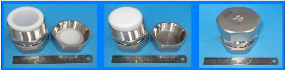
**Figura 12:** Autoclave usada na síntese das zeólitas.
