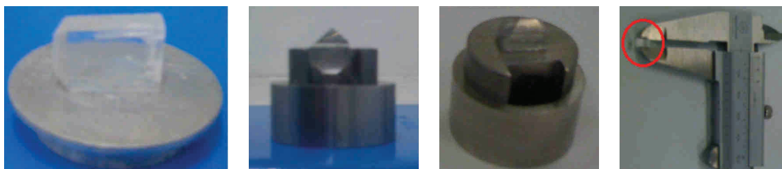
Figura 23: Cristal pronto para experimento após o processo de polimento.
