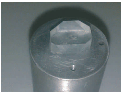
Figura 13: Cristal de ADP, forma prisma + pirâmide ( estrutura tetragonal )
