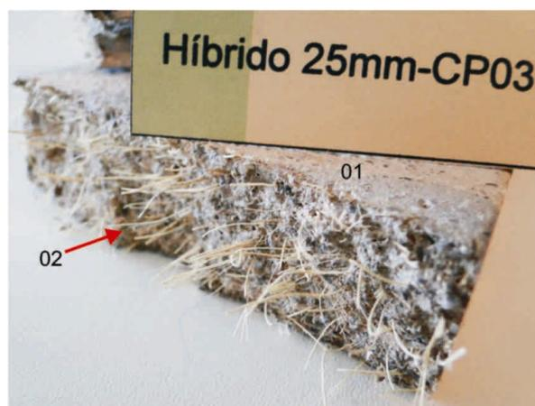
Figura 67 Secção transversal do corpo de prova do compósito híbrido 25 mm apresentou boa distribuição do material reforço em toda a secção descrita pela seta 02. (01. Superfície de compressão; 02. Homogeneidade)
