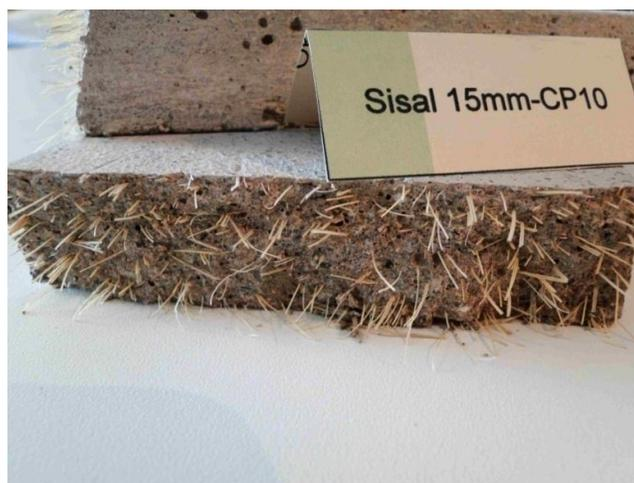
**Figura 42** Seção transversal do corpo de prova do compósito sisal 15 mm apresenta boa distribuição do material reforço em toda a seção
