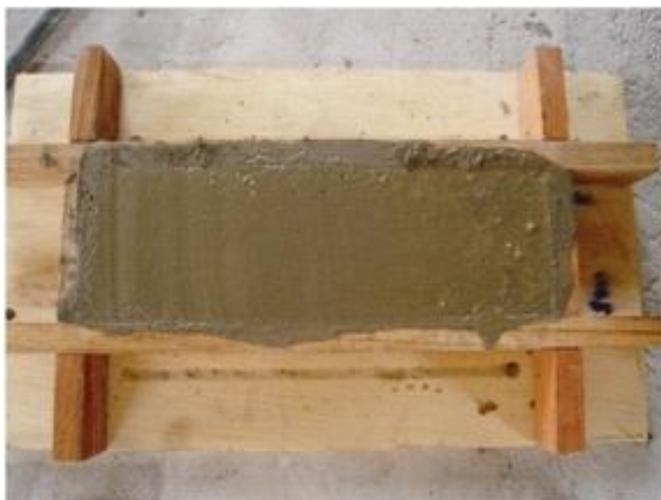
**Figura 23 Molde totalmente preenchido com material compósito onde já foi efetuado a vibração mecânica para o nivelamento da superfície**
