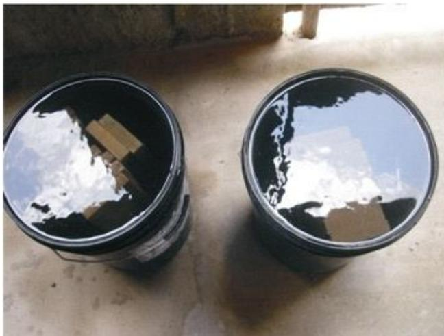
**Figura 25** Cura submersa, onde as amostras ficaram num tambor com água por 28 dias, antes do ensaio mecânico
