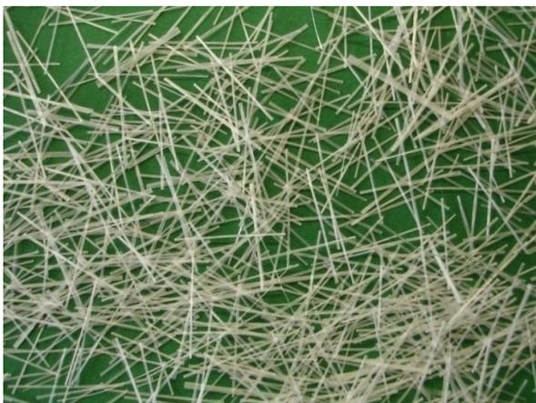
**Figura 2 Fibras de vidro cortadas**
