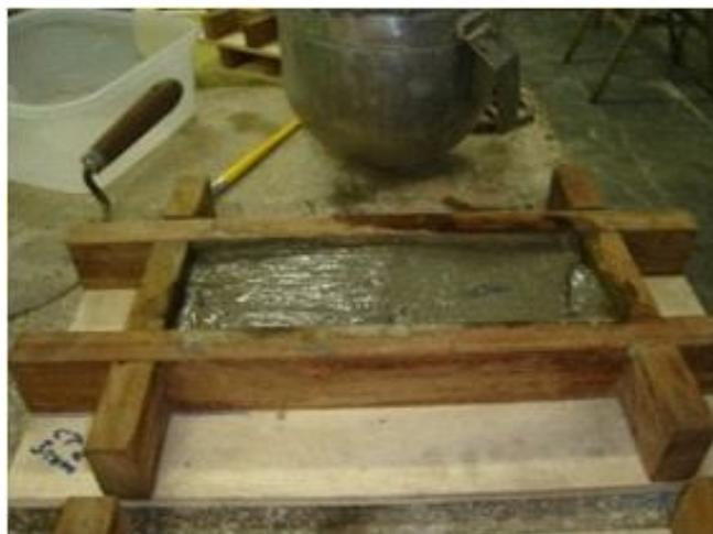
**Figura 22** Molde sendo preenchido com material compósito
