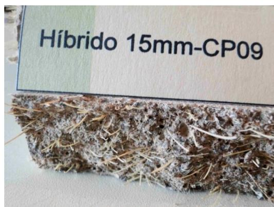
**Figura 62** Seção transversal do corpo de prova do compósito híbrido 15 mm apresentou boa dispersão do material reforço em toda a seção
