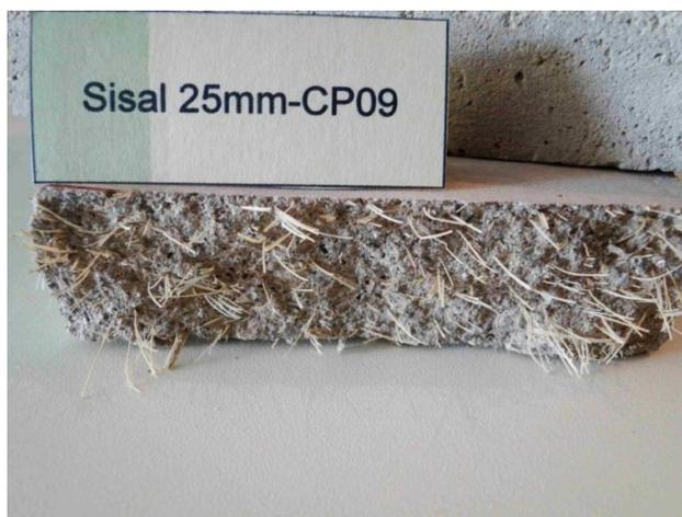
**Figura 51** Secção transversal do corpo de prova do compósito sisal 25 mm apresentou boa distribuição das fibras do material reforço em toda a secção
