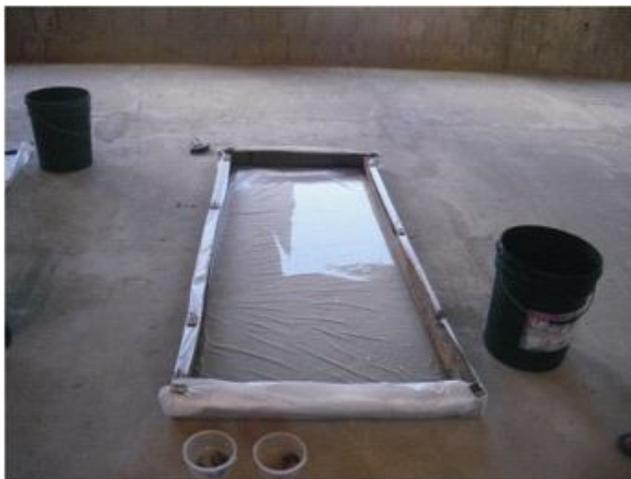
**Figura 24** Câmara úmida onde as amostras ficaram durante o processo de cura antes da desmoldagem
