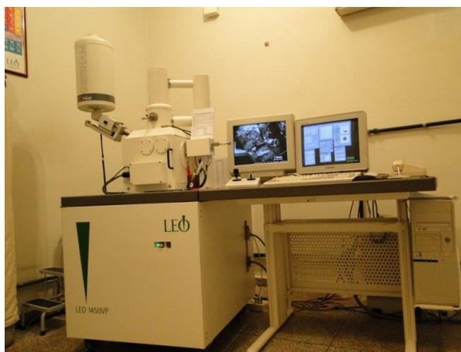
**Figura 30 MEV - Microscópio eletrônico de varredura usado para a caracterização micro estrutural**
