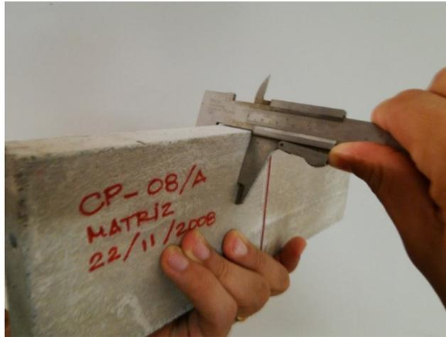
Figura 28 Aferição dos CPs com uso do paquímetro
