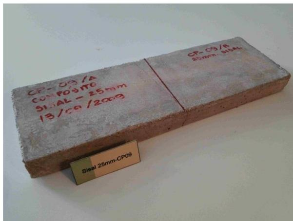
**Figura 48** CP reforçado com fibra de SISAL25 mm antes do ensaio
