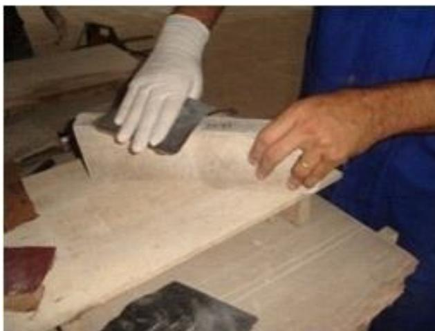
Figura 27 Lixamento dos corpos de prova com lixa 180
