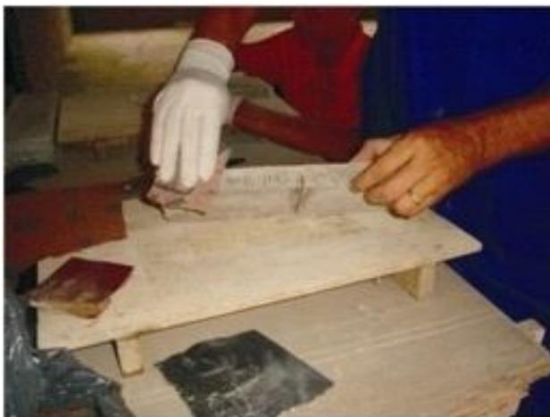
Figura 26 Lixamento dos corpos de prova com lixa 100
