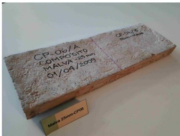
**Figura 54 CP reforçado com fibra de malva 25 mm – MALVA25 usado no ensaio de flexão em três pontos**
