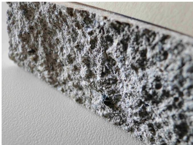
**Figura 35** Seção transversal do corpo de prova da matriz plena mostra o aspecto rugoso típico da superfície de fratura de matriz frágil
