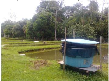
Figura 7 – Tanque de fibra de vidro com capacidade para armazenar 1000 L.
