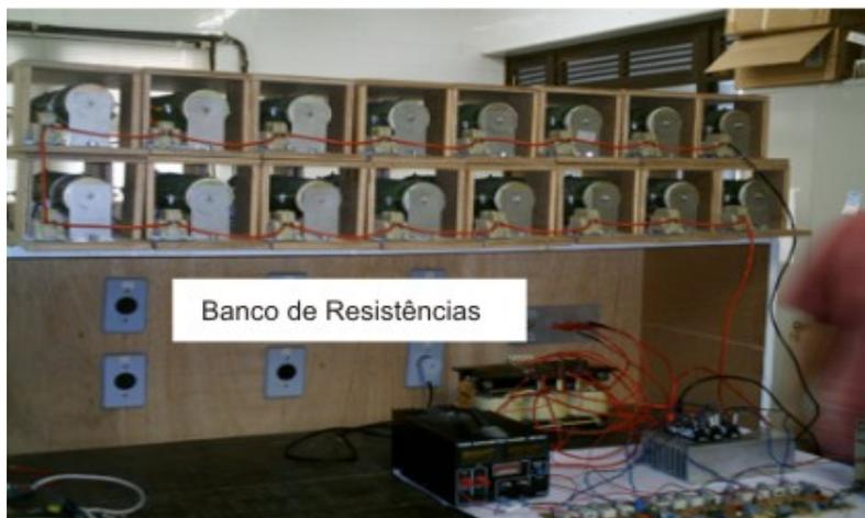
Figura 7.8. Vista geral do conjunto de resistências utilizadas durante os ensaios.
