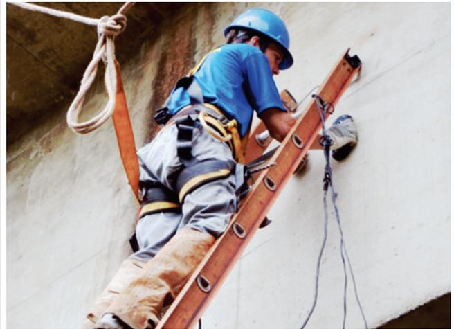
Figura 9 – Ensaio de pacometria no tubulão T7
