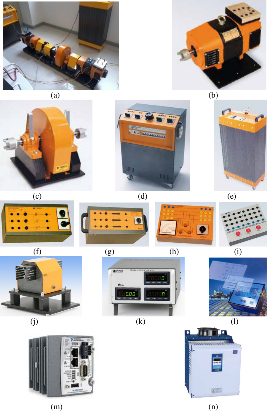
Figura B.1 – SGER com cadeia de medição e controle associadas: a) Grupo Gerador: Motor CC a direita; Gerador Síncrono a esquerda; simulador de inércia no centro; b) Gerador síncrono de 1,2 kVA c) Simulador de inércia; d) Fonte de tensão trifásica variável; e) Carga resistiva; f) Carga capacitiva; g) Carga indutiva; h) Sincronizador automático; i) Simulador de curto-circuito; j) Transdutor de torque e potência mecânica; k) Unidade de processamento digital de torque e potência mecânica; l) Multimetro de grandezas elétricas; m) Controlador digital industrial NI cRIO-9025; n) CTW-04 Driver de acionamento do Motor DC
