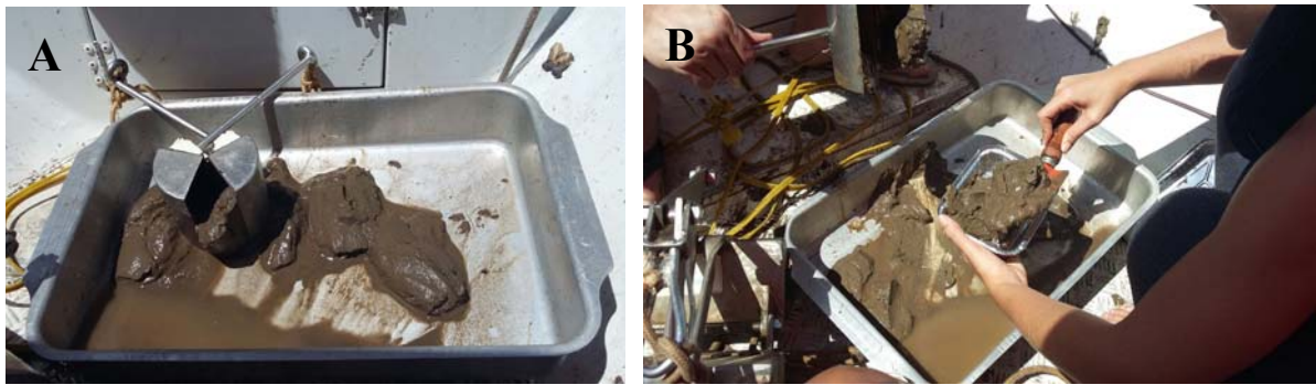
Figura 4.3 - (A) Coleta e (B) armazenamento das amostras de sedimento superficial em recipientes metálicos.
