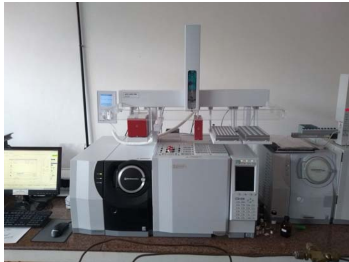
Figura 4.5 - Cromatógrafo gasoso acoplado a espectrômetro de massa triploquadrupolo modelo GCMS-Tq8040 (Shimadzu) com ionizador de elétrons.
