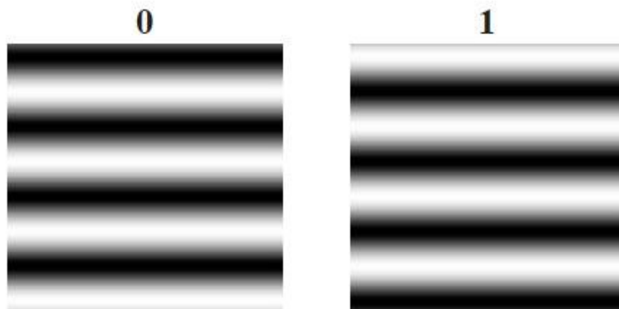
Figura 12. Esquema demonstrativo da estimulação por redes senoidais acromáticas, com reversão de fase de 180^\circ controlada temporalmente por sequência- m . A sequência é criada pelo sistema Veris Science 6.10 , com valores binários como 0 e 1, por exemplo, e é lida em intervalos de tempo constantes: quando o valor do passo lido é igual a 0, a rede senoidal acromática é apresentada em seu estado padrão, e quando é lido o valor 1, apresenta-se a rede senoidal em seu estado reverso. Durante a observação do estímulo pelo sujeito, o VECP é registrado e, a partir de correlação cruzada entre o estímulo apresentado a resposta provocada, é possível a extração de kernels .
