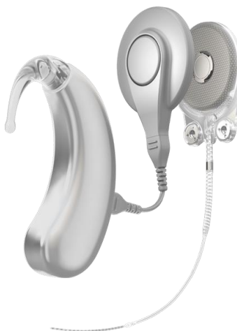
Figura 23 – Implante coclear: estrutura externa e interna.
