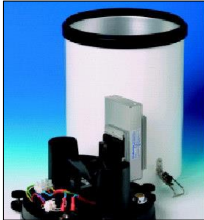
Figura 6 – Pluviógrafo com mecanismo de registro em meio magnético.
