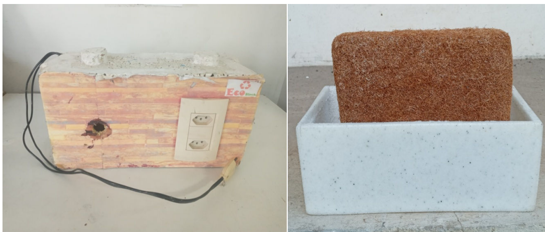
Figura 4.4- Bloco com instalação elétrica e com manta acústica.
