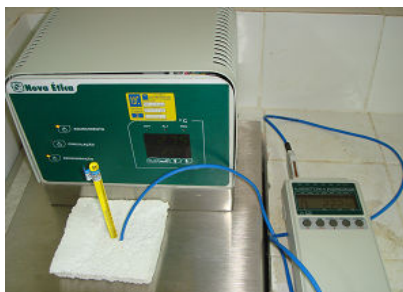
Figura 3.7- Banho termostático para aferição de termopares.
