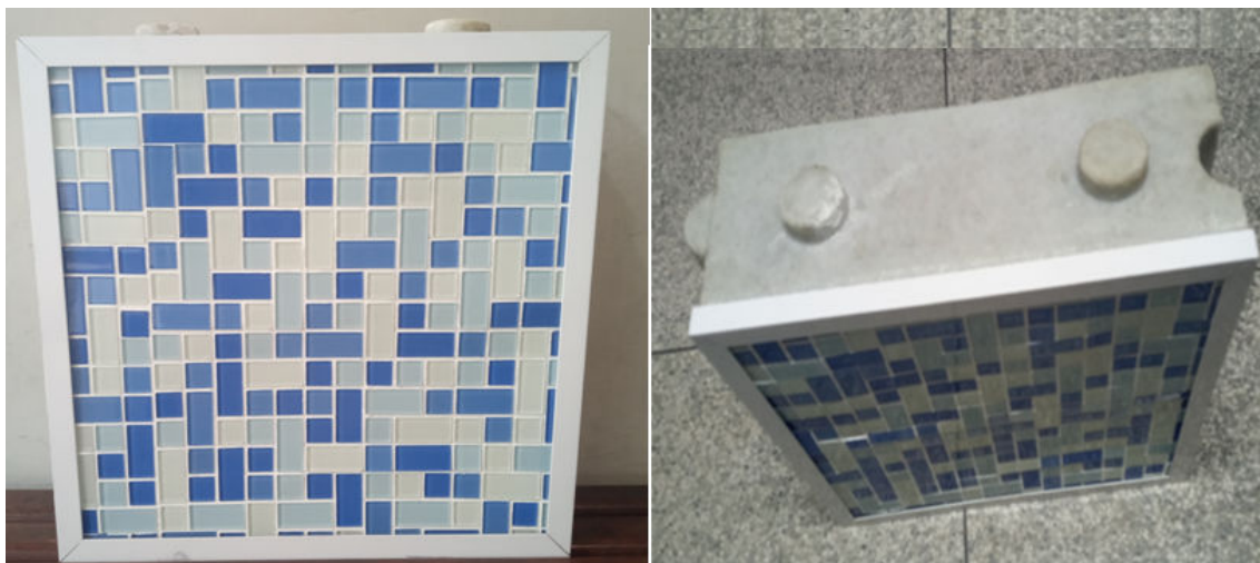
Figura 4.2 - Bloco de PEAD com revestimentos e elementos de encaixe.
