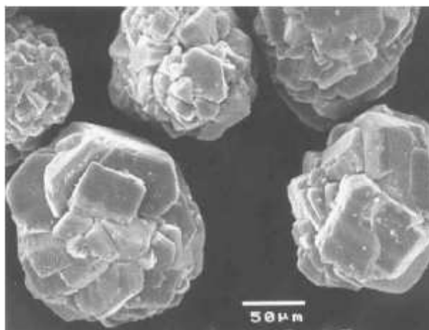
Fig 4 Microscopia eletrônica de varredura da \gamma -Alumina produzida em 773 K.
