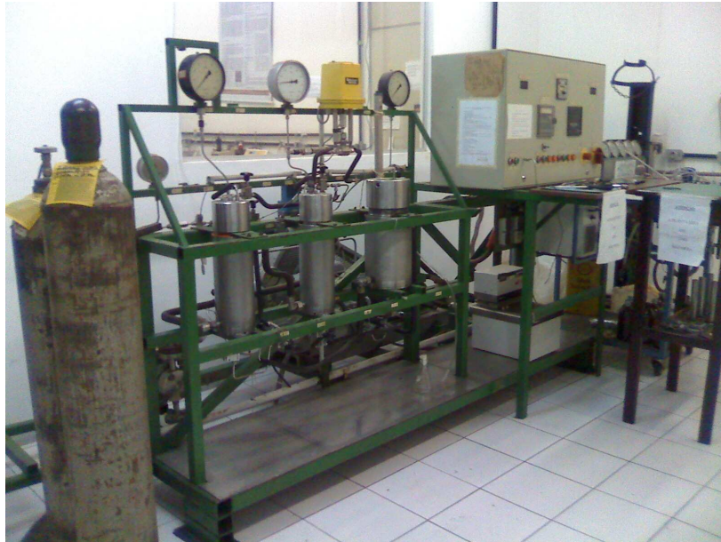
Figura 3.10 Unidade piloto de extração supercrítica
