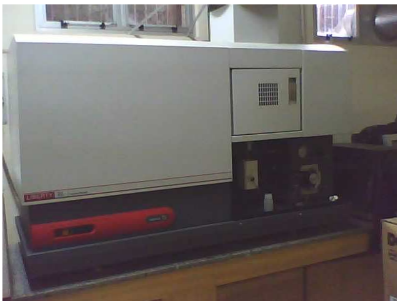
Figura 3.7: Equipamento de Espectrografia de Emissão
