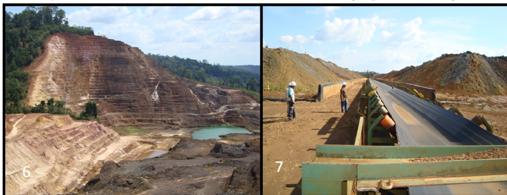
Fotografia 7 - Pilhas de minério em beneficiamento via cianetação para concentração de ouro.
